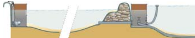
Die Pumpe entnimmt auf der linken Seite des Filtergrabens das Wasser. Dadurch sinkt der Wasserspiegel im Graben und entsprechend im Saugsammler.
